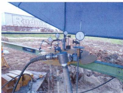
Foto 2 – Detalhe instrumentação para execução da prova de carga estática bidirecional
