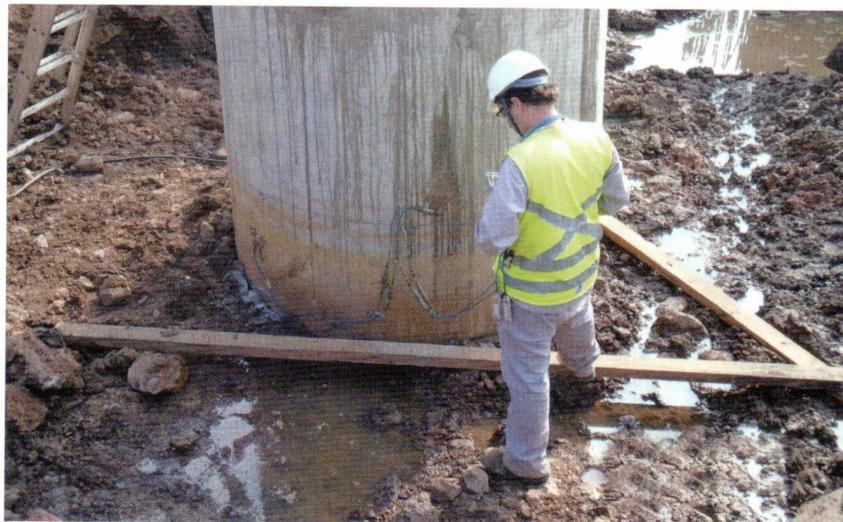
Foto 5 – Bloco de impacto e fixação dos sensores
