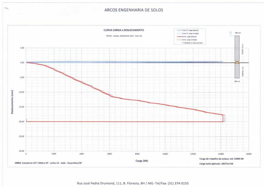
Figura 8 – Resultados da prova de carga estaca 45 – Eixo 76
