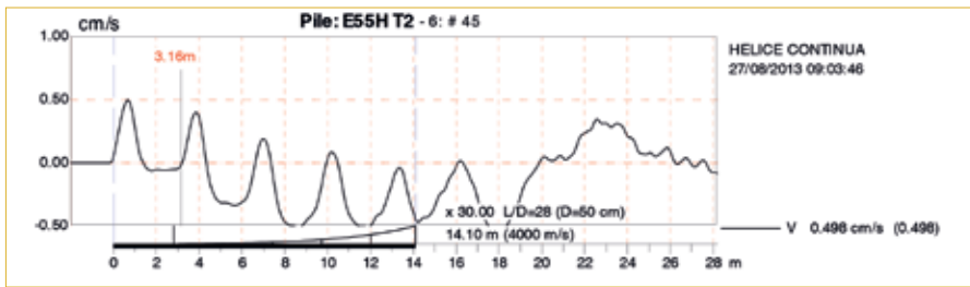
Figura 17 – Sinal PIT – Estaca com 14,10 m de comprimento
