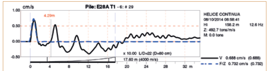
Figura 6 – Sinal PIT – Estaca com comprimento de 17,6 m
